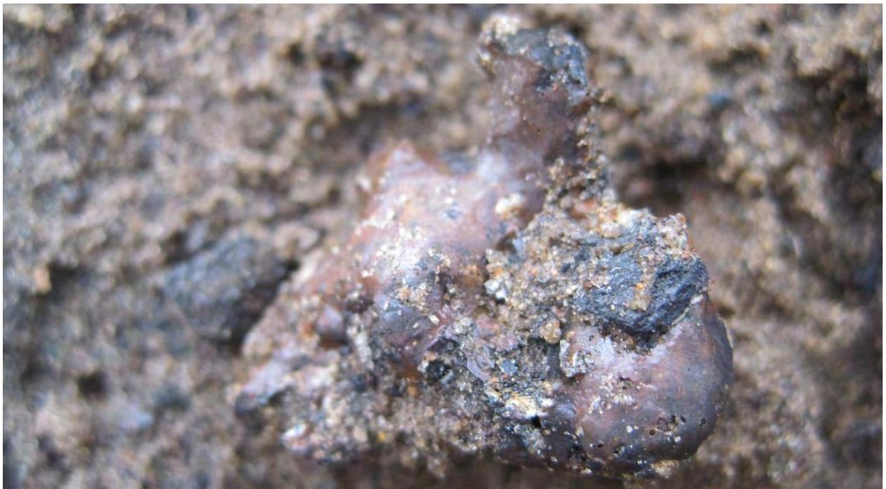
*Foto 15: Schurf 6 – verglaste Hüttenschlacke (05006 – MP.T4)*
