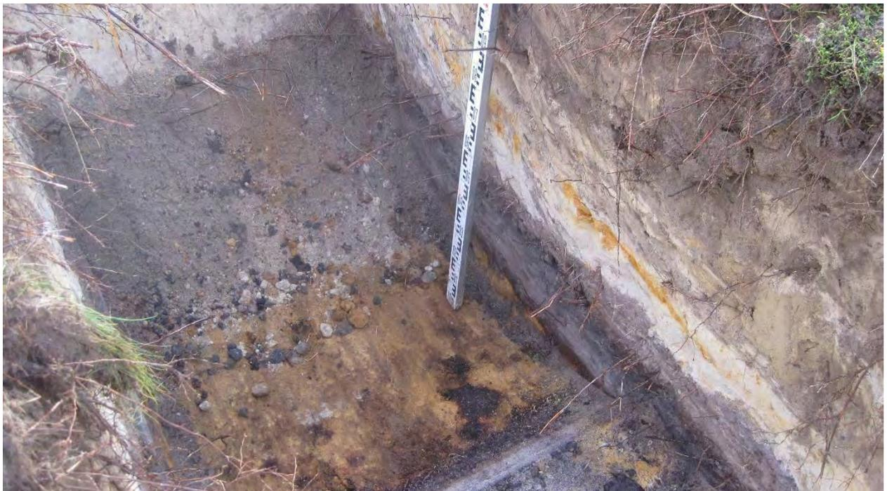
*Foto 17: Schurf 7 – Schlackenablagerungen in der Sohle (05007 – MP.T1)*
