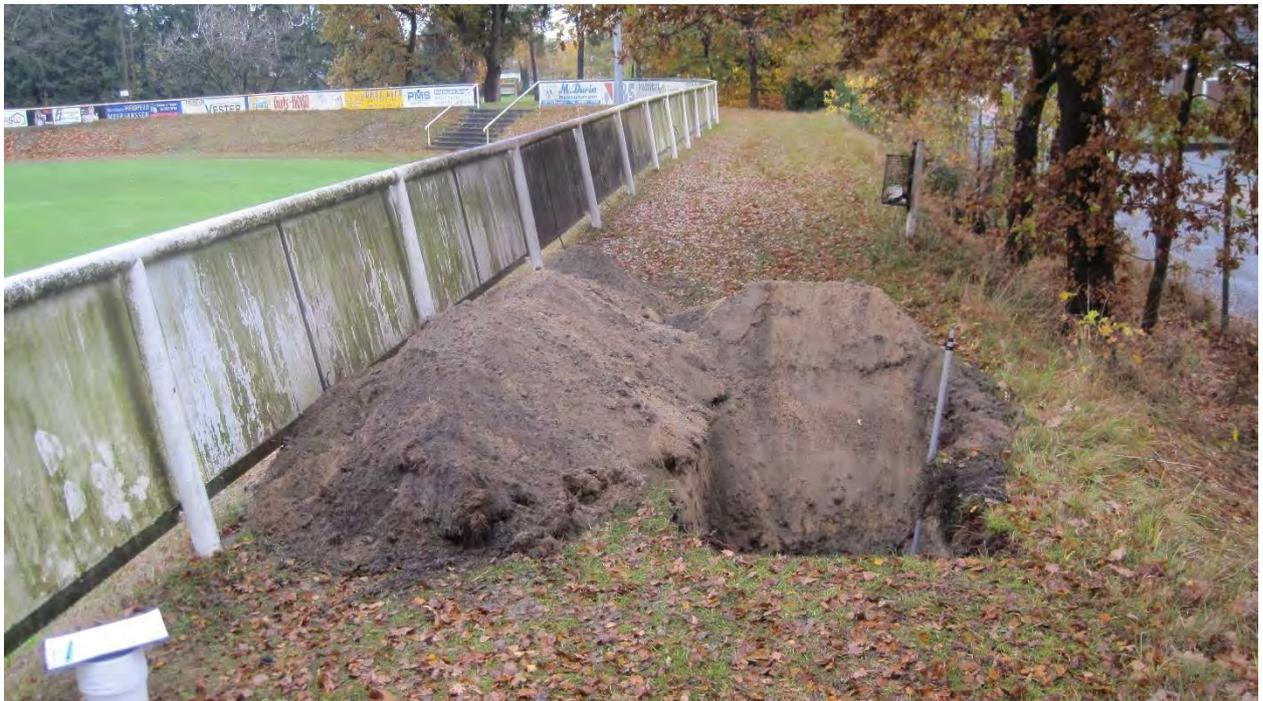
*Foto 22: Schurf 10 – humose Sandauffüllung mit Schlackenbeimengungen im unteren Segment (05010 – MP.T3)*
