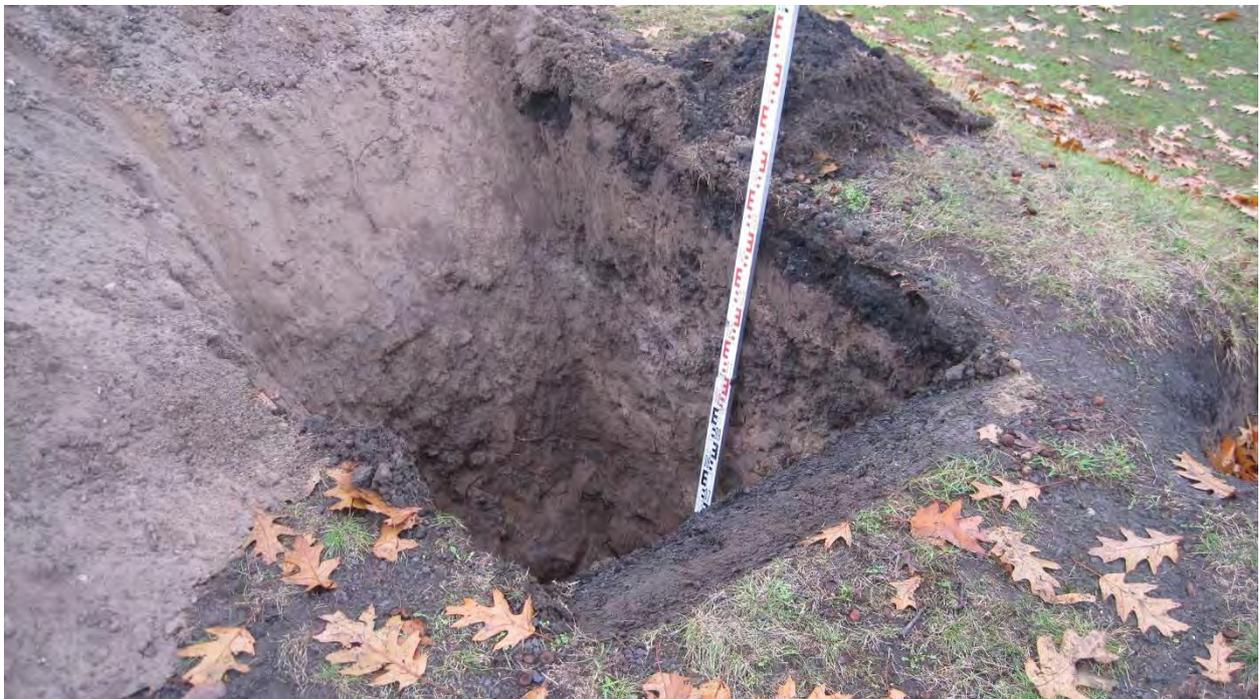
*Foto 27: Schurf 12 – ab ca. 0,6 m GOK intensive Schlackenbeimengungen in 1,0 m Mächtigkeit (05012 – MP.T4)*
