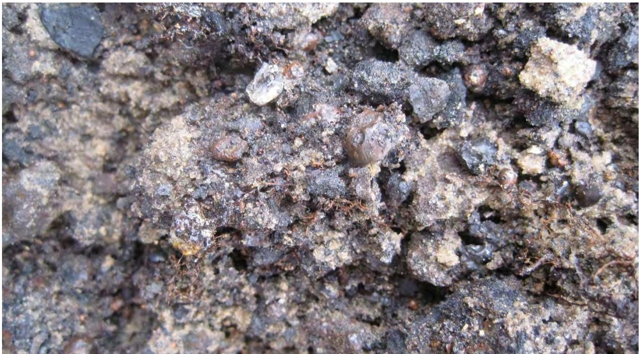
*Foto 9: Schurf 4 – Schlackenablagerung in der Sohle (05004 – MP.T3)*
