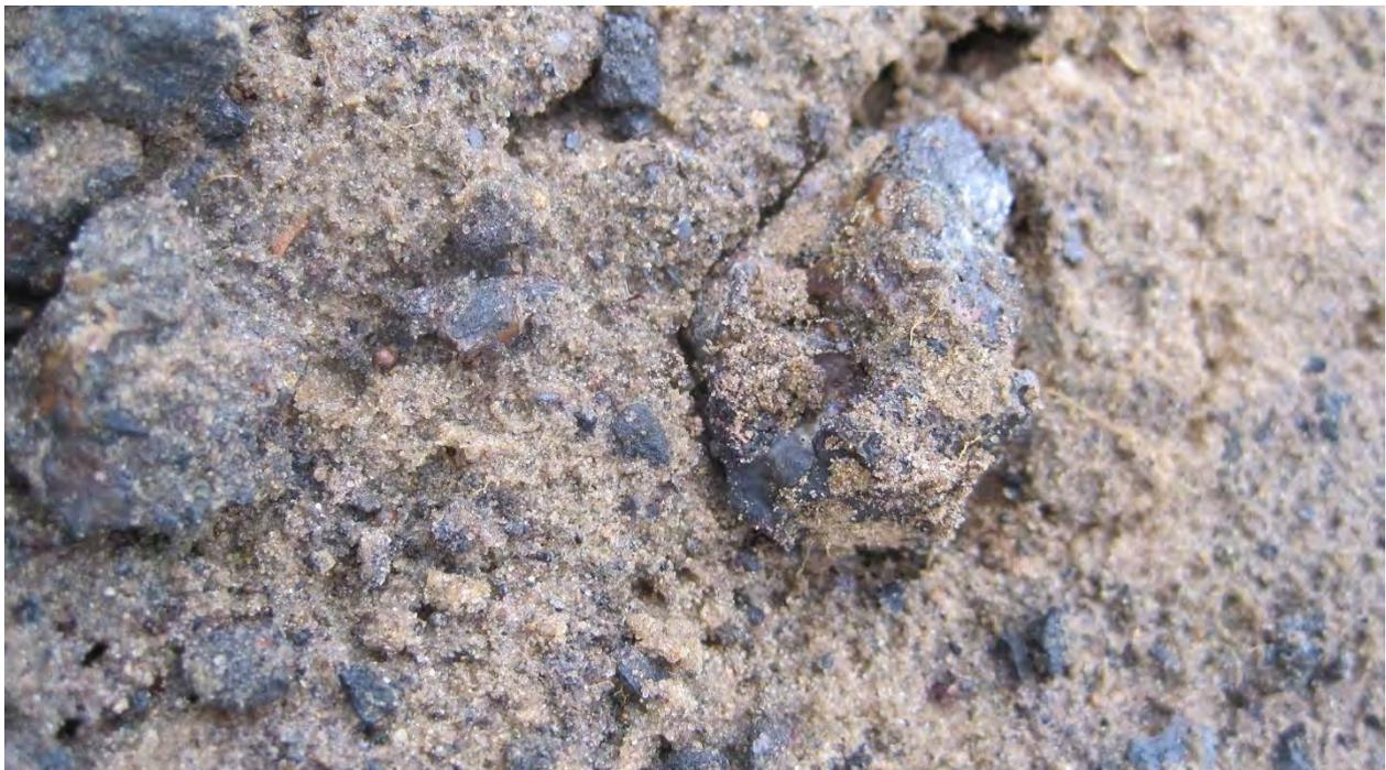
*Foto 11: Schurf 5 – Schlackenbeimengungen in der Sohle (05005 – MP.T3)*
