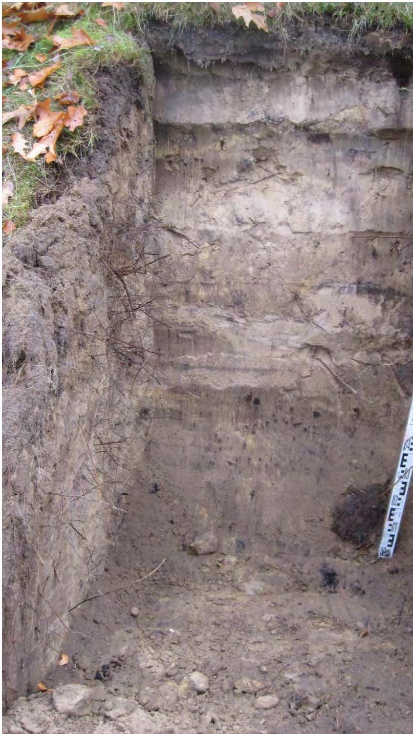
*Foto 7: Schurf 3 – reine Sandauffüllung, Düne mit humosen Einschlüssen (05003 – MP.T2)*
