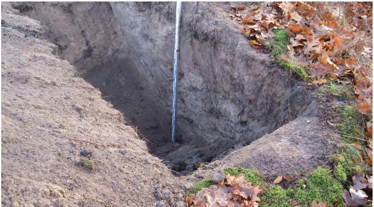
*Foto 19: Schurf 8 - Sandauffüllung mit deutlichen Humusanteilen und wenigen Schlacken in der Sohle (05008 - MP.T2)*
