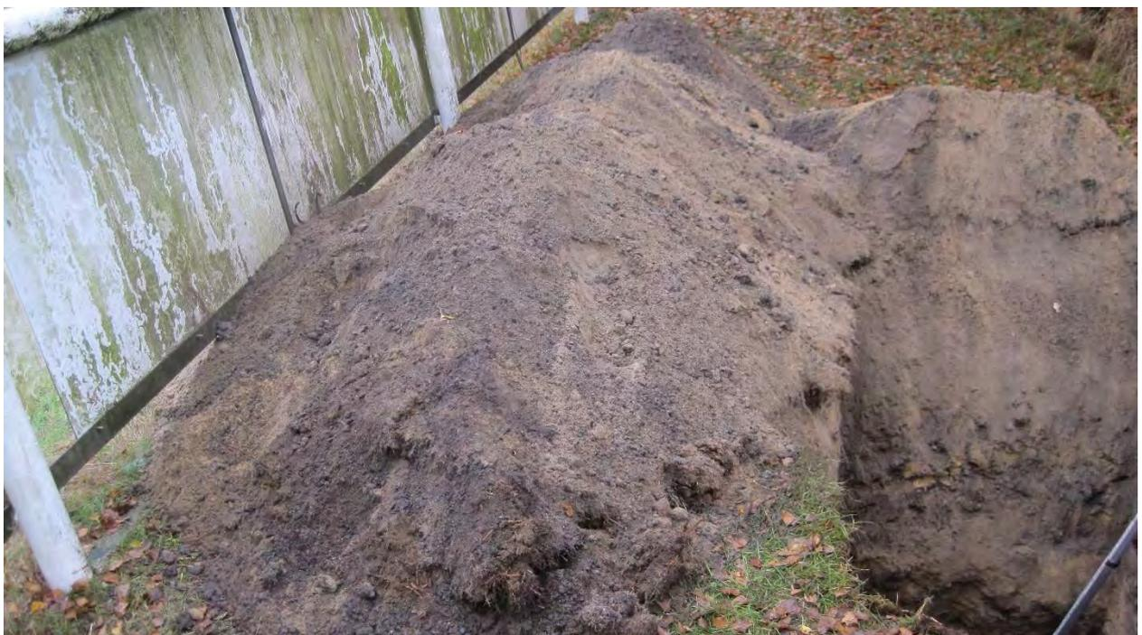
*Foto 23: Schurf 10 -Aushub mit Schlackenbeimengungen aus dem unteren Auffüllungssegment (05010 – MP.T3)*
