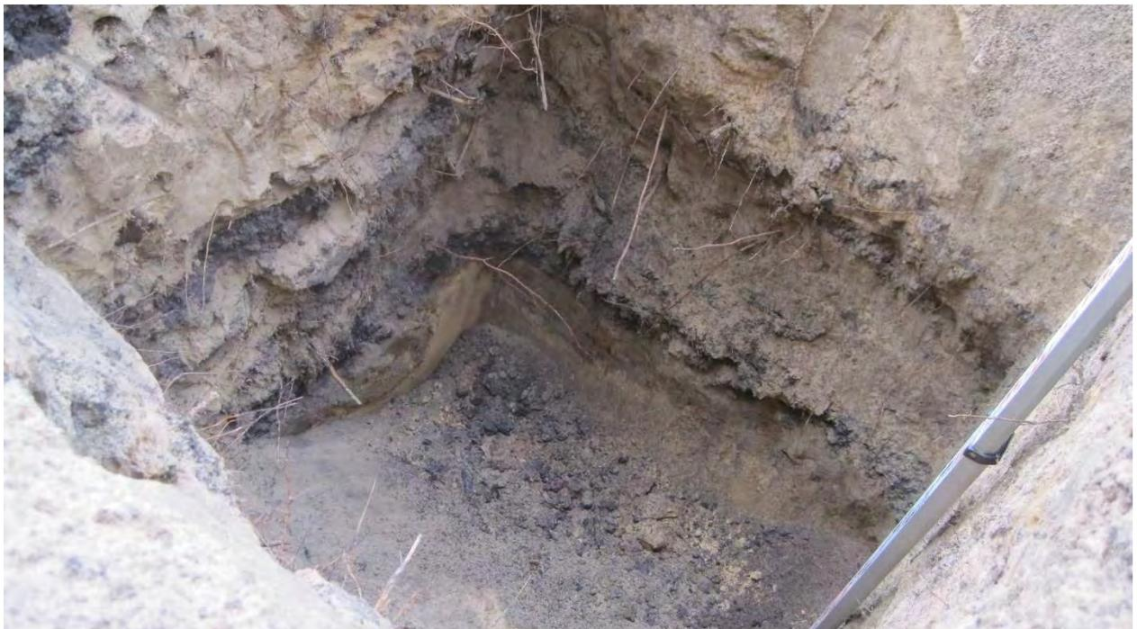
*Foto 25: Schurf 11 - mehrere signifikante Bänder von Schlackenablagerungen in der sandigen Auffüllung (05011 - MP.T4)*
