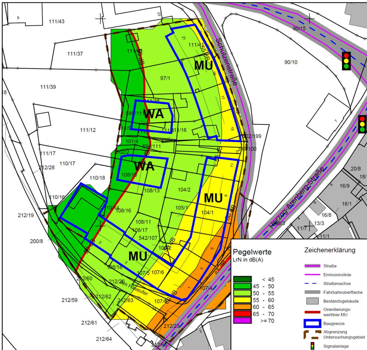
**Bild 4:** Isophonenkarte Nacht (22-6 Uhr) – Auszug aus Karte 2 der Anlage, Berechnungshöhe: 4 m, ohne Maßstab, genordet
