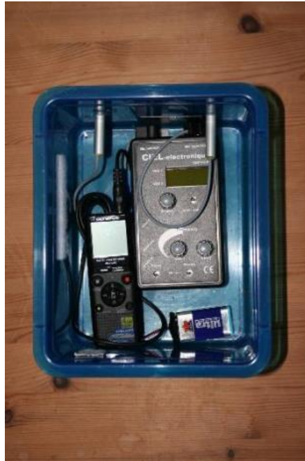
Abbildung 5: Beispiel für den Aufbau einer Horchkiste
